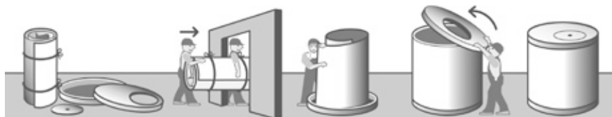
Haase kommt. Bringt die Teile in den Keller. Baut den Tank auf. Fertig!
