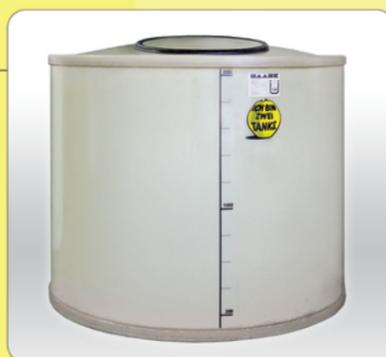
Für die Herstellung von Haase-Tanks wird Glasfaserverstärkter Kunststoff (GFK) eingesetzt. Dieser hochwertige Werkstoff ist formstabil, geruchsdicht, alterungsbeständig und 100 %-ig korrosionsfrei. Durch die transparente Tankwandung kann man mit einem Blick sehen, wieviel Öl noch vorrätig ist.
